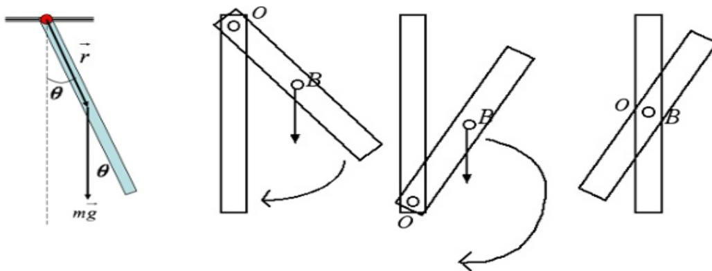
fig.6 L'asta come pendolo composto (a sinistra); fig.7 Equilibrio stabile, instabile e indifferente in un'asta infulcrata (a destra)
